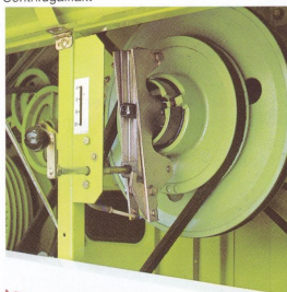
Reglering av luftmängden
