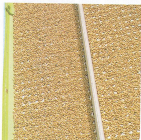
3D-rensverket fördelar materialet jämnt över sällytan
