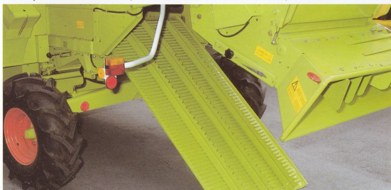
Utdragbart förberedningsplan för enkel och snabb rengöring
