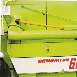
Hydrauliskt svängbart tömningsrör
