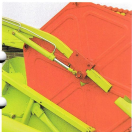
Hydraulisk horisontalförskjutning av haspeln (tillbehör)
