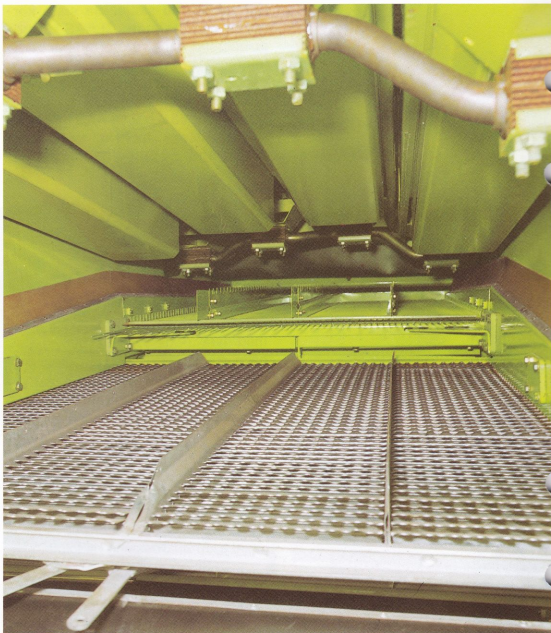
Stor sålyta. Stållbara lamellisäll. Spillindikator som känner av hela bredden på tröskverket
