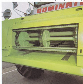
Extra kraftig inmatningskanal med elevator
